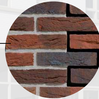
metselwerk Engels Doetinchem waalformaat wildverband voeg lichtgrijs terugliggend
