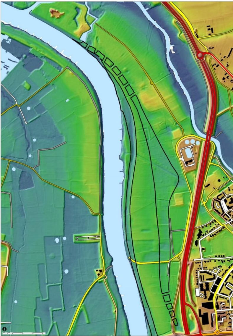
Figuur 5. Reliëfvormen, zoals Maasgeulen en zandopduikingen, zichtbaar aan de hand van actuele hoogtemetingen (AHN). De geulen zijn met zwarte contouren aangegeven.
