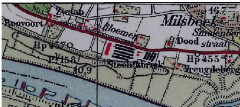
Detail uit de topografische kaart van 1938. De fabriek na de modernisering door Huisman met een nieuwe ringoven (in rood aangegeven langwerpige rechthoek) en reeksen haaghutten (dikke zwarte strepen) Watwaswaar.nl
