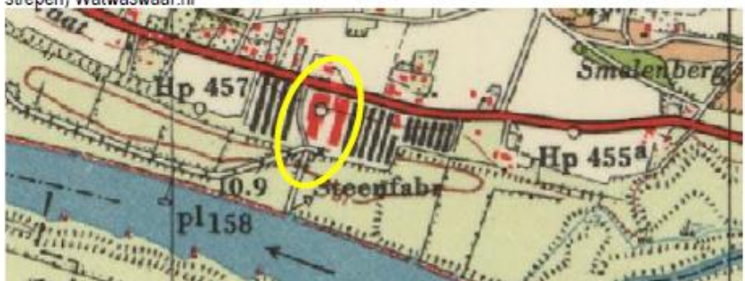
Detail uit de topografische kaart van 1958. Oostelijk van de later gesloopte oven zijn reeds het kantoor, werkplaats en een grote hal (gebouwen G, H, en J) zichtbaar. Binnen de gele ovaal het vanaf 1946 gebouwde complex met loods, werkplaats, kantoor, ringoven en bazenwoning. De haaghutten staan haaks op de Bloemenstraat. Watwaswaar.nl Hieronder situatie in 1967
