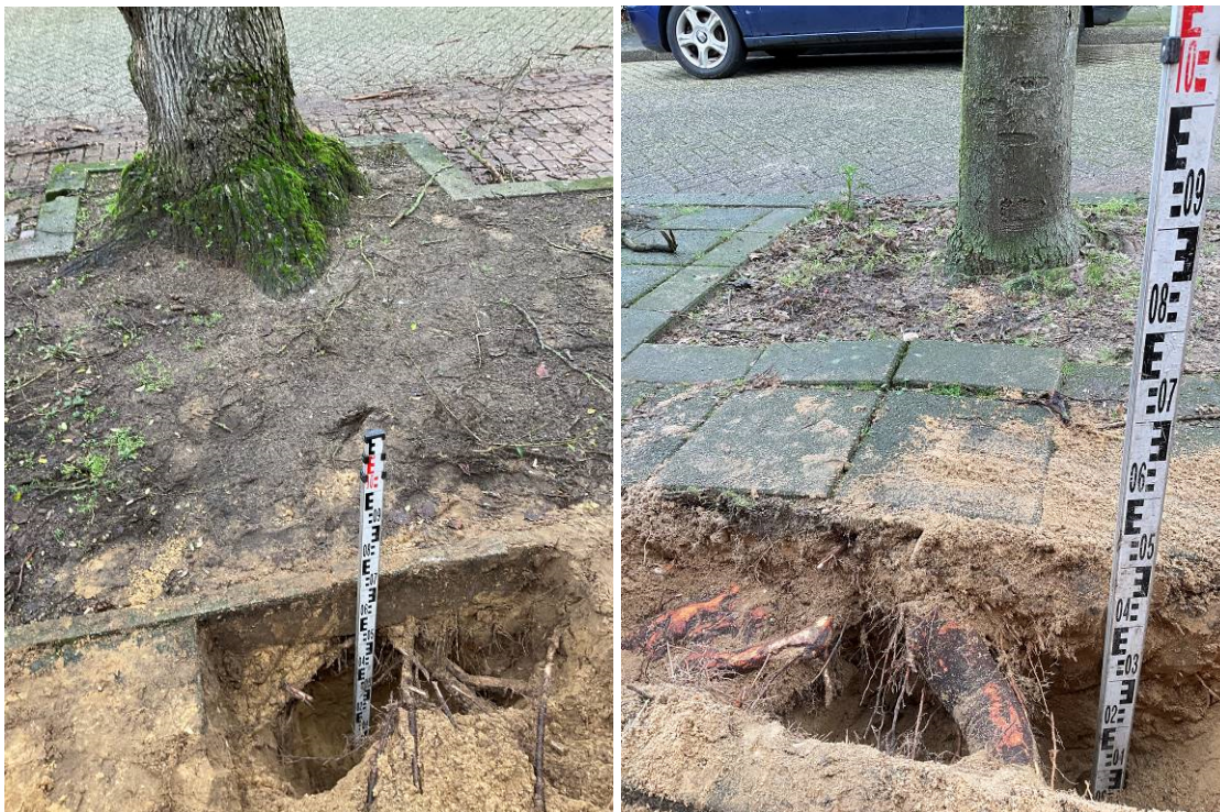
Foto 7 en 8: Beeld van het bewortelingprofiel bij de pluimiep met boomnummer 22 (links) en bonte gewone esdoorn met boomnummer 34 (rechts) aan de Leeuwerikstraat.
