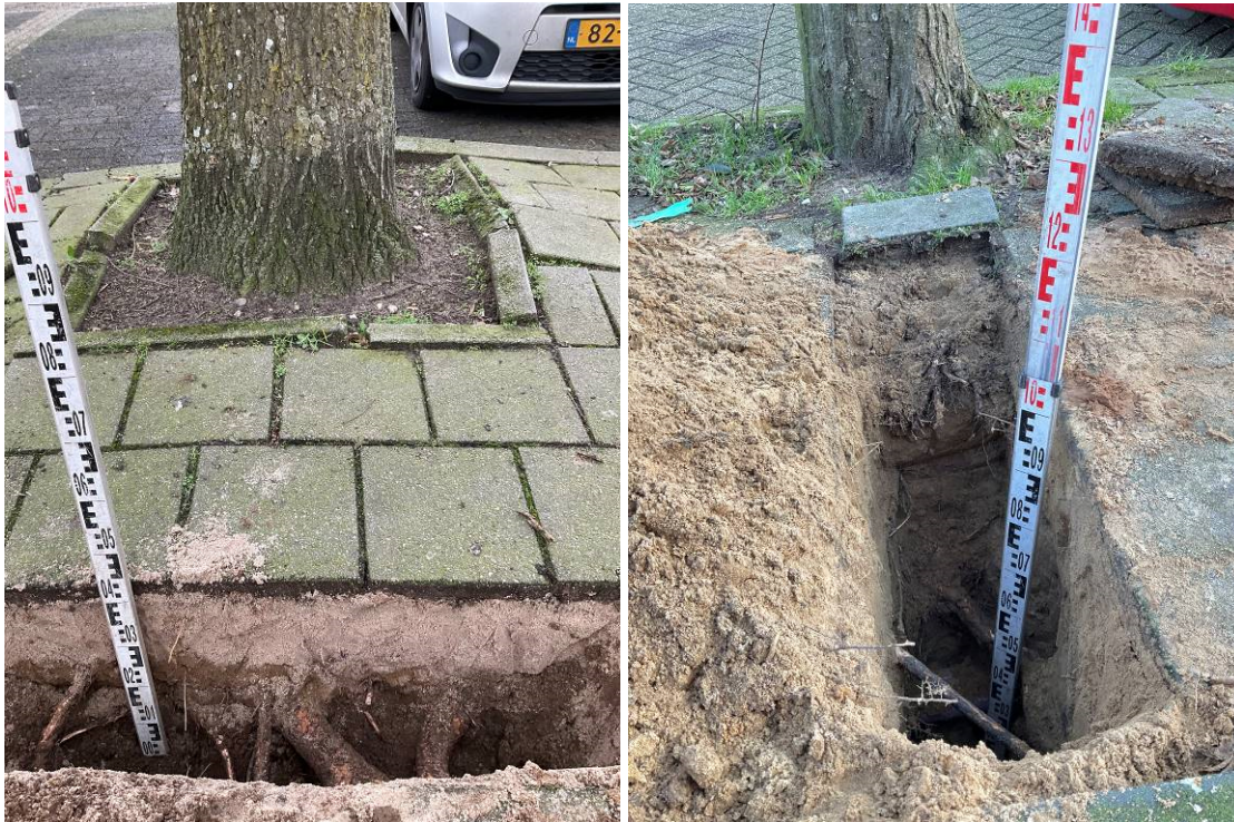
Foto 5 en 6: Beeld van het bewortelingprofiel bij de moseik met boomnummer 3 aan de Prins Hendrikstraat (links) en haagbeuk met boomnummer 15 aan de Patrijsstraat (rechts).
